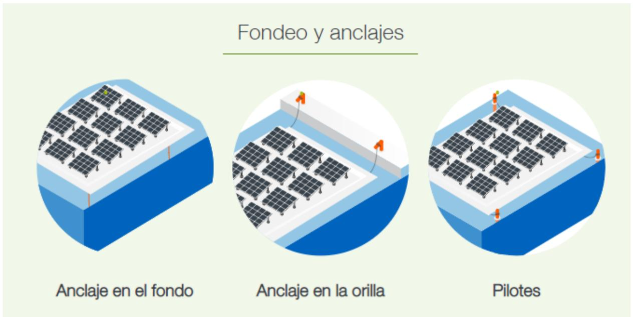
*Ilustración 32 Tipos habituales de anclajes, imagen extraída de IBERDROLA,
