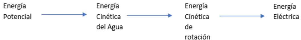
En la presente imagen se puede apreciar, de una manera simplificada, el proceso del paso de energía potencial del agua que se acumula en las represas, pasando por energía cinética del agua y de rotación para terminar convirtiéndose esto en energía eléctrica. Dependiendo de la potencia generada por las centrales hidroeléctricas estas pueden llegar a clasificarse en diferentes tipos de plantas:
