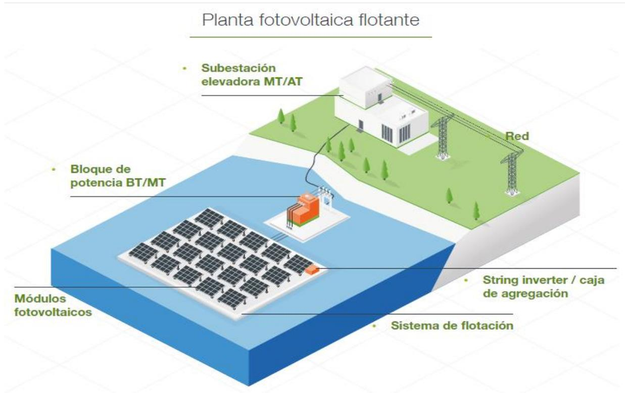
Ilustración 30 planta fotovoltaica flotante, imagen extraída de IBERDROLA, <https://www.iberdrola.com/innovacion/fotovoltaica-flotante>
