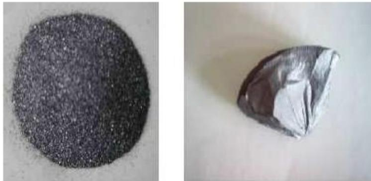
*Ilustración 17 Muestras de silicio amorfo (izquierda) y silicio cristalino (derecha), imagen extraída del texto de Martínez. A, 2011*
