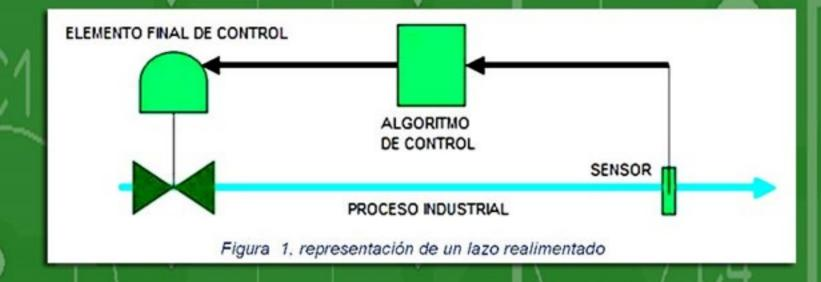
De esta manera, el lazo de control es capaz de mantener el proceso estable, seguro y rentable, manteniendo la variable controlada en su valor deseado. Uno de los algoritmos de control continuo más utilizado en el mundo es el lazo de control Proporcional Integral Derivativo (PID) por la sencillez de su configuración, flexibilidad para adaptarse a cualquier tipo de proceso y su eficacia en lograr el objetivo de mantener las variables de proceso dentro de los valores deseados.
