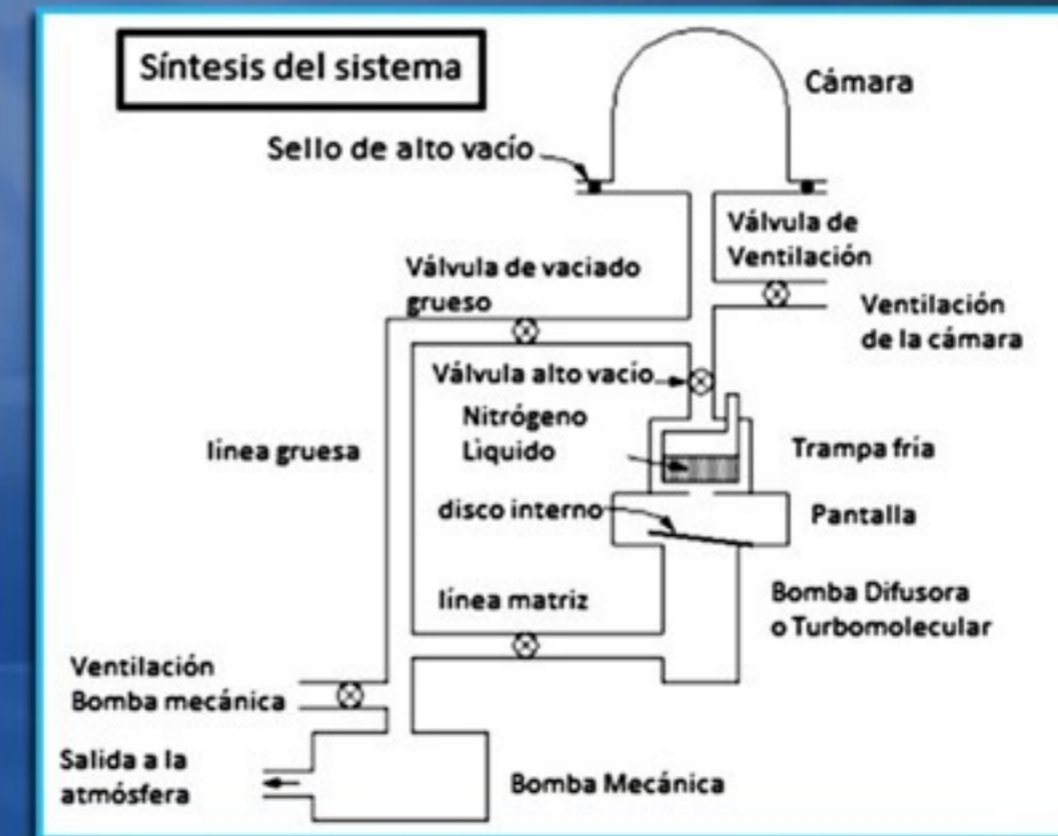
Figura 1: esquema de vacío convencional para experimentos de nanociencia. Como se puede apreciar, son sistemas complejos, difíciles de armar, manejar y mantener.
