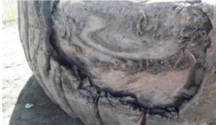
Imagen 9. Neumático con separación por calor.
